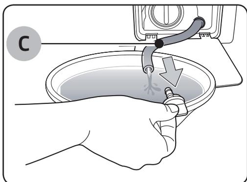
4. Abra a tampa do cano e deixe a água no **cano de drenagem de emergência (C)** fluir para dentro do recipiente.
