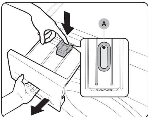
1. Enquanto pressiona e segura a **alavanca de liberação (A)** na parte interna do compartimento, deslize-o para abrir.
