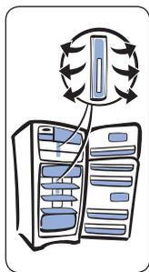
Este sistema tem a função de distribuir o ar frio para o resfriamento dos alimentos no compartimento freezer e refrigerador.
