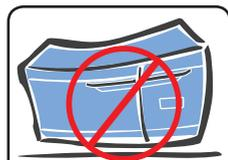
Em caso de necessidade de transporte, não deite o refrigerador para a direita (para quem olha o refrigerador de frente).
