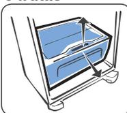
Levante a extremidade anterior da tampa da gaveta de legumes/verduras e frutas e retire-a puxando a tampa até travar e depois levante-a.
