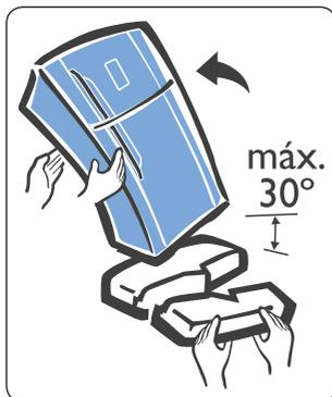
Incline cuidadosamente o refrigerador para um dos lados e quebre esse lado da base para removê-la.
