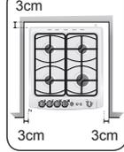
Se possível, instale o botijão fora da cozinha, em local protegido e bem ventilado.
