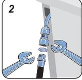
2. Encaixe o anel de vedação dentro do adaptador e fixe o tubo flexível metálico ao adaptador, usando duas chaves ajustáveis.
