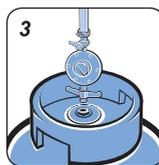
3. Conecte o regulador de gás ao botijão, apertando-o somente com as mãos. Este sistema foi desenvolvido para vedação somente com a força "manual", não necessitando ferramentas.
