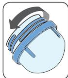
Para evitar choque elétrico ao instalar, trocar ou limpar a lâmpada, assegure-se de que o fogão esteja desligado da tomada. Para a retirada do protetor de vidro da lâmpada, gire-o no sentido anti-horário (para a esquerda).
