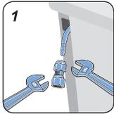
1. Fixe o adaptador para "bico de mamadeira" na entrada de gás do fogão usando duas chaves ajustáveis (chave inglesa).
