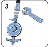
3. Encaixe o anel de vedação dentro da outra extremidade e fixe o tubo flexível metálico no regulador de pressão com registro de rosca externa 1/2", usando a chave ajustável.
