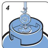
4. Ligue o gás e verifique se existem vazamentos utilizando o detergente líquido viscoso, que garante um melhor desempenho e eficácia do teste.
