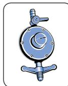
Use sempre um regulador de pressão para qualquer tipo de botijão. A ausência deste pode causar excesso de pressão e vazamento de gás. O regulador de pressão do gás deve ser de 2,75 (2,8) kPa de pressão e, no mínimo, 1kg/h de vazão, exclusivo para o fogão (condição para gás GLP). Verifique o prazo de validade do regulador de pressão. Na troca, observar que o regulador de pressão do gás deve ter gravado as letras NBR 8473 (norma brasileira).
