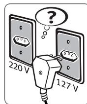
O plugue atende a nova regulamentação da NBR. Verifique se a tomada está no novo padrão. Os pinos dos plugues possuem 4,0mm no modelo CL07F e 4,8mm no modelo CL07R
